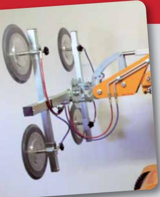
Das Vakuumsystem des Lifts ist in zwei separate Kreise unterteilt, für höchste Sicherheit. Hier sind Vakuumsysteme mit blauen bzw. roten Vakuumschläuchen zu sehen.
