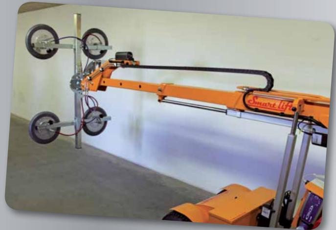
Neben dem elektrischen Ausschub ist der Hebearm mit einem zusätzlichen manuellen Ausschub ausgestattet, mit dem eine besonders große Reichweite erzielt wird.
