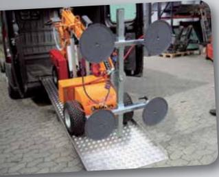
Der Transport des Lifts erfolgt in einem Transporter oder auf einem Anhänger.
