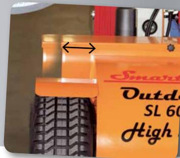
Der SL 608 Outdoor ist bis zu 100 mm seitenschiebbar zur Feinjustierung beim Fenstereinbau.
